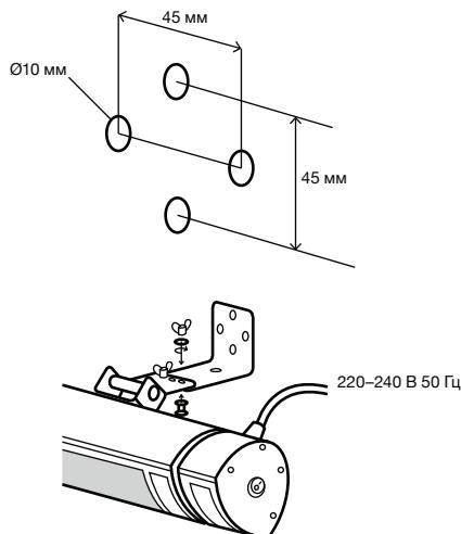
Рис. 1. Настенный кронштейн , крепежные винты. Установка Устройства на стену
